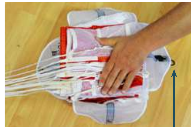
Position de la boucle élastique, à l'opposé des suspentes
