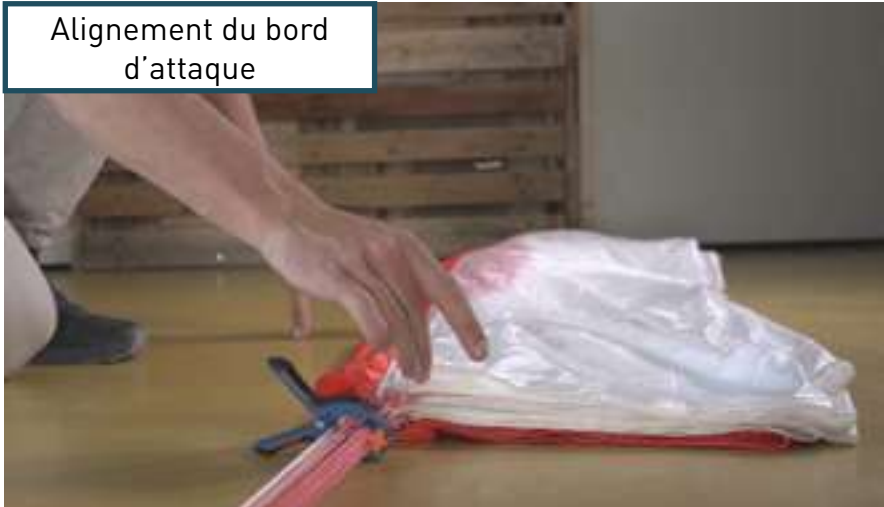
Mise à plat du premier panneau
