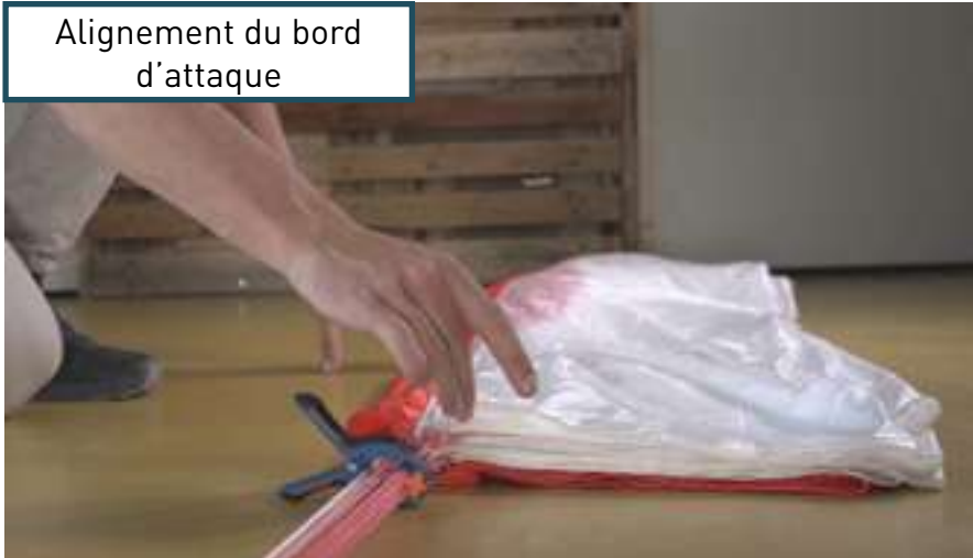
Mise à plat du premier panneau
